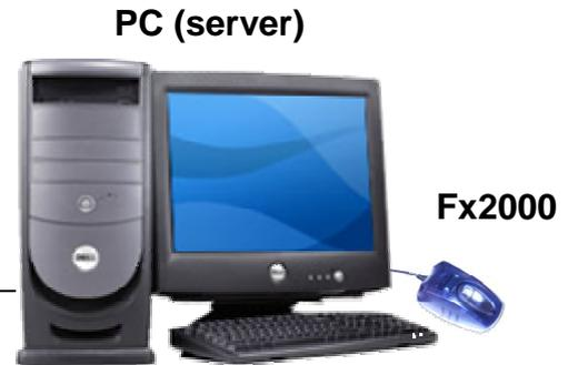
Il PC server, tramite l'applicazione **FxAccessControl** (o altra applicazione sviluppata tramite FX Gate SDK), gestisce in modo centralizzato l'intero sistema. Le registrazioni degli utenti possono essere effettuate tramite scanner da tavolo Fx2000 collegato al server. I terminali continuano ad essere operativi anche in caso di "caduta" della rete.
