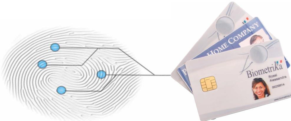
La soluzione **PKCS#11** di Biometrika utilizza lo scanner Fx3000 e una Smart Card come un unico **token crittografico ad attivazione biometrica**.
